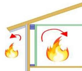
ツーバイフォー工法は、火の通り道となる床や壁において、枠組材などが、ファイヤーストップ材となって空気の流れを遮断し、上階への火の燃え広がりを防止します。その高い耐火性は火災保険料率に反映されています。省令準耐火構造の住宅とは、建築基準法の準耐火構造に準ずる防火性能を持つ構造として、住宅金融支援機構の基準に適合する住宅をいいます。
