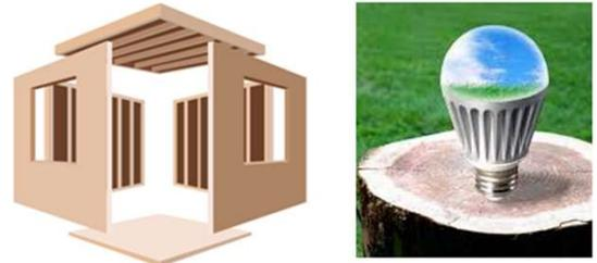
面構造を基本にした6面体ができあがると家全体が強いモノコック構造（一体構造）となり、極めて強固な剛性を持ち、特に地震に対しての強さに定評のある工法です。また、ツーバイフォー住宅の屋根は強風に対して、優れた強度を備えています。台風以上に強烈なハリケーンが襲う北米で生まれただけに、強風に備える独自のアイデアが採用されているのです。
