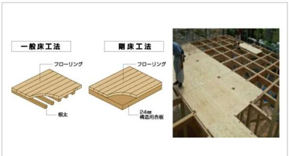
「剛床工法」とは、根太を設けず床下地合板を厚くして、直接梁材に留め付ける床組み工法で、一般的な「根太工法」に比べ地震や台風時に発生する水平力に対して強い造りです。また床を厚くすることでたわみが減少し、床鳴りが発生しにくくなると同時に、耐火性能も上がります。
